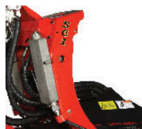
Zbiorniki z cieczą koloryzującą umieszczone na ramie głowicy.
